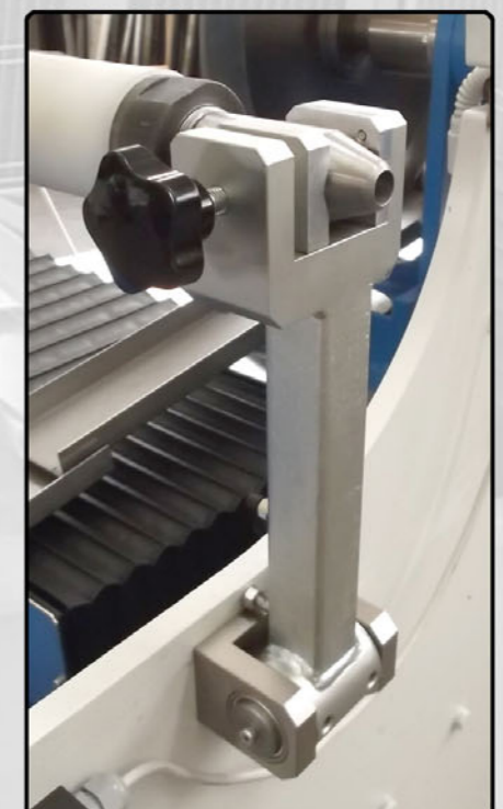
Manuelle Vorrichtung zur Blockierung der Rollenwelle Manual locking mandrel device
