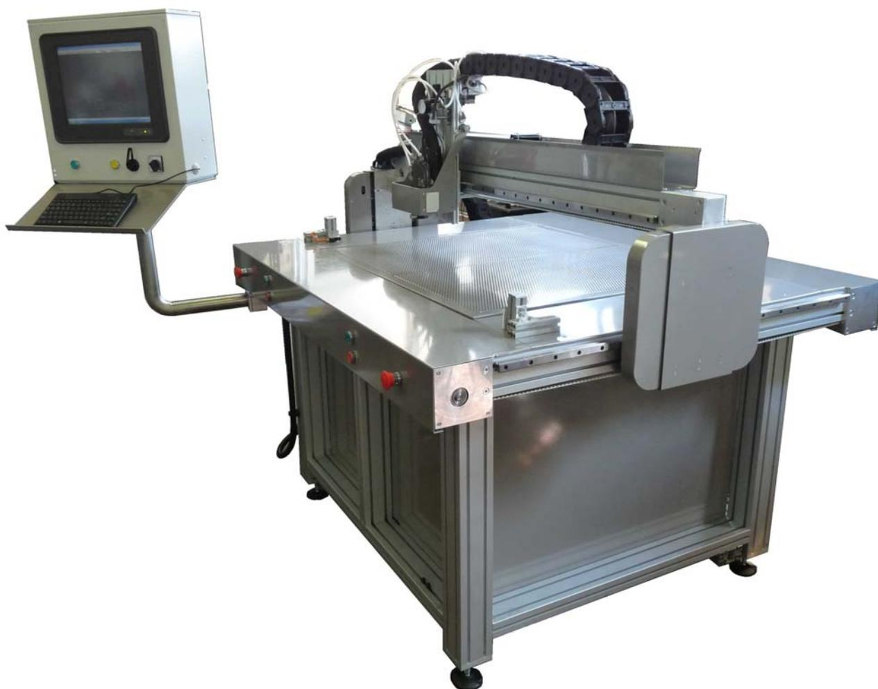
**Macchina per adesivi hot melt e viniliche, esegue cordolo hot melt, spray hot melt e cordolo vinilico.**
